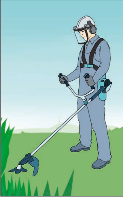
الشكل 24 - ب. إستخدام آلة جني يدوية لتقليل حمل العمل على عضلات ذراعيك ويديك. ركّب مقبضاً يدوياً على الأداة للإمساك بها بأمان.
