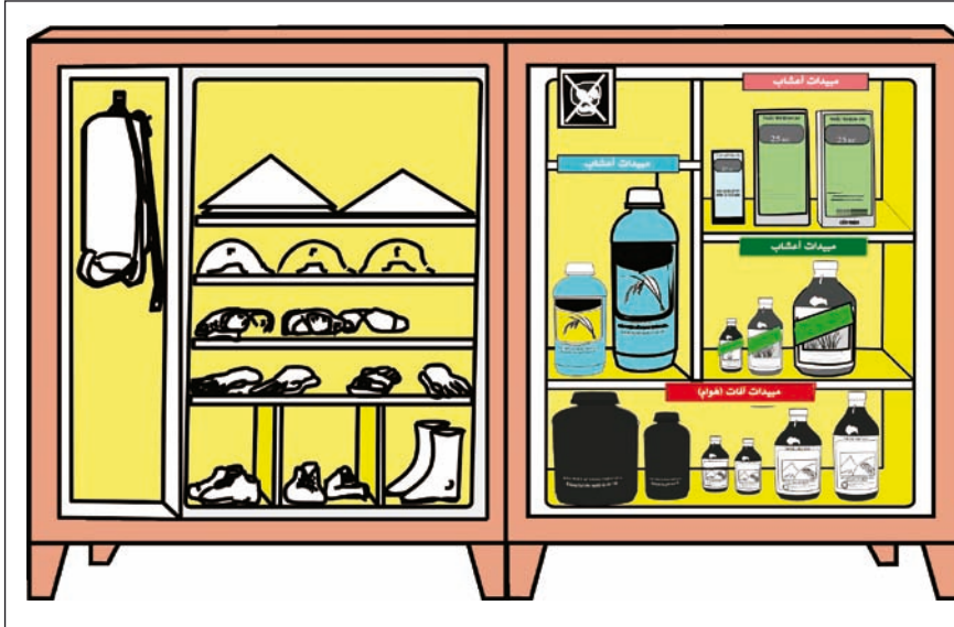
الشكل 63 - ت. حَزَّنُ المواد الكيميائية الزراعية منفصلة عن بعضها البعض ومنفصلة عن الوسائل والأدوات الزراعية الأخرى، كوسائل الرش والقفازات والأقنعة. ينبغي أن توضع بطاقات التعريف الواضحة على كافة عبوات المواد الكيميائية، وأن تُرتَّب تلك العبوات على نحو منطقي.
