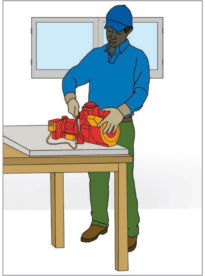
الشكل 27 - أ. عدّل طاولات العمل لتُحَقِّق الارتفاع الصحيح لسطح العمل وفقاً لنمط العمل المؤدى.
