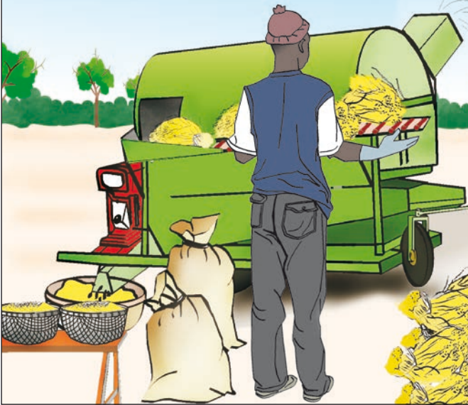
الشكل 31 - ب. يمكن لجزء التلقيم في الآلة أن يكون أعلى كي يؤدي العمل بوضعية الوقوف الاعتيادية.
