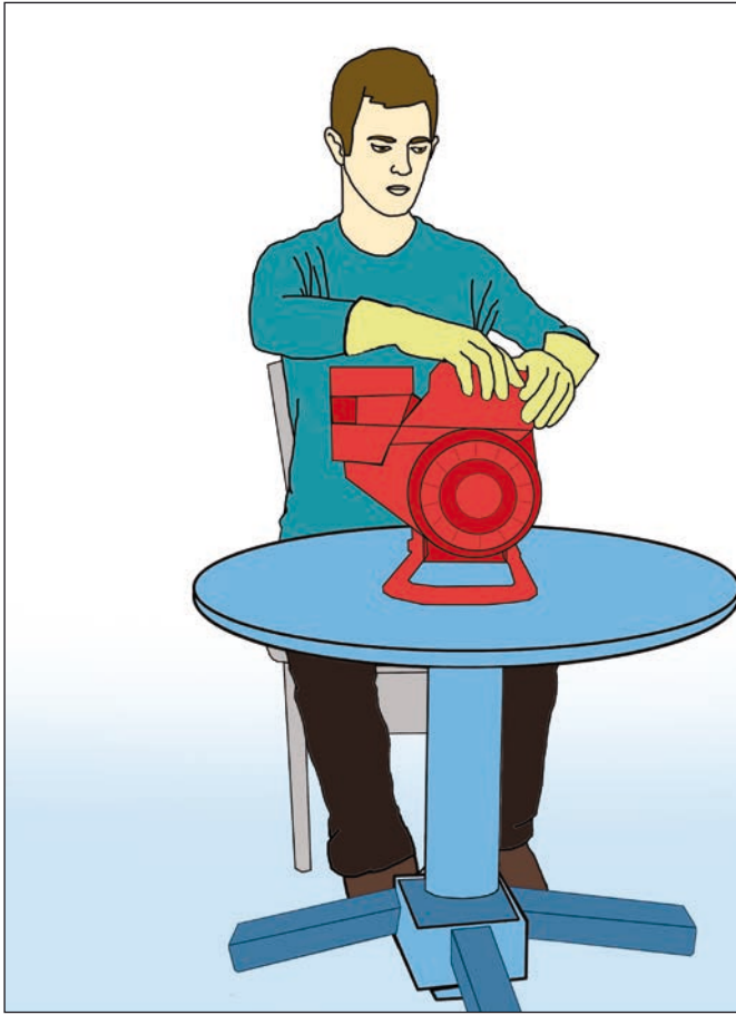
الشكل 27 - ب. إن منصات العمل الدوارة تجعل من السهل العمل على الأشياء من اتجاهات مختلفة.
