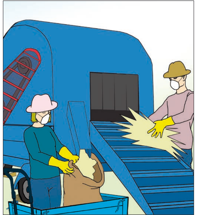
الشكل 31 - أ. وسيلة تلقيم على شكل سير ناقل ينقل حزم الرز إلى داخل الجزء الخطير في آلة الذّرس.
