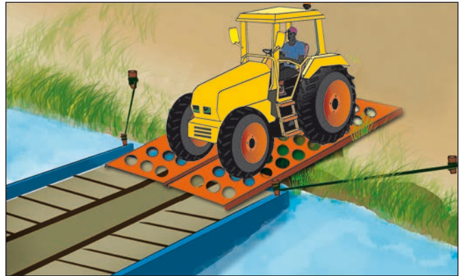
الشكل 44 - ت. جَهَّزُ بمنصات ثابتة لتشكيل طريق للمركبات للدخول إلى المركب والخروج منه.
