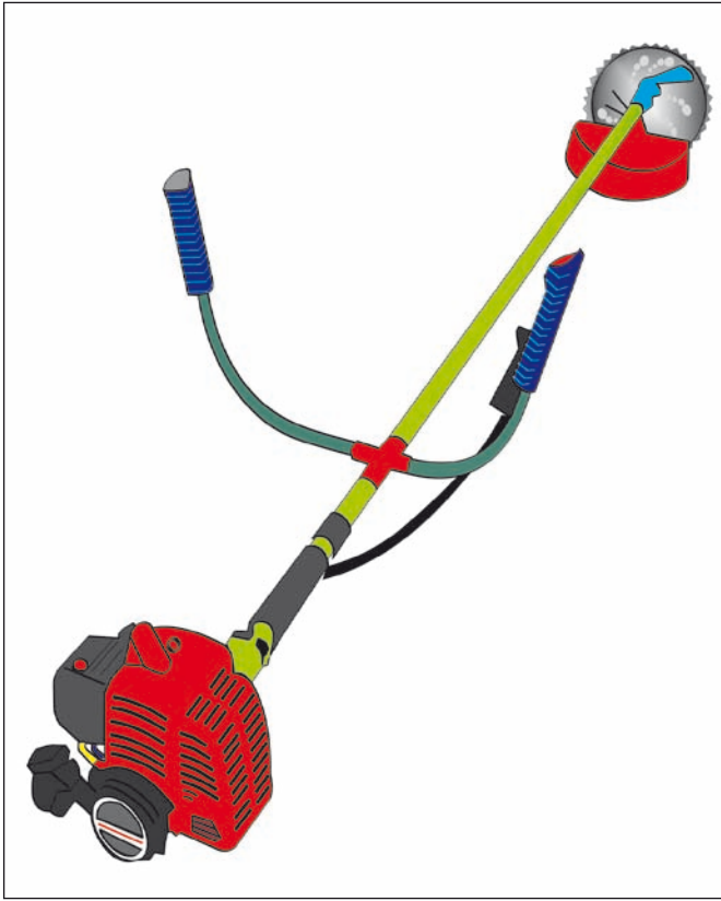
الشكل 30 - ب. وسائل حماية خاصة ضرورية للأدوات المستخدمة يدوياً لحماية اليدين والقدمين من الحركات غير المتوقعة للأدوات.
