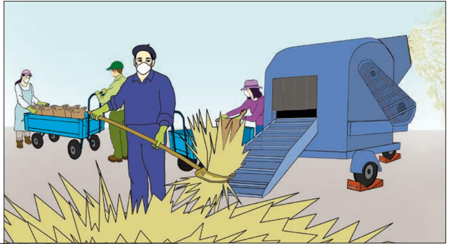
الشكل 32 - أ. استخدم الأسافين لتثبيت الآلات ذات العجلات، أو استخدم آلات مزودة بحصيرة جر جنزيرية.
