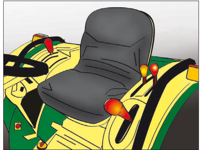
الشكل 48 - ت. تساهم وضعيات التحكم وترتيبات الجلوس بالرؤية الجيدة لما حول المركبة.
