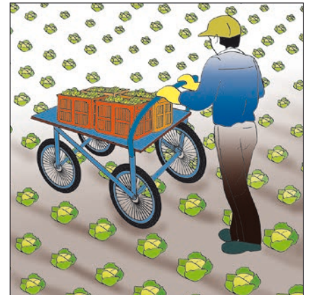
الشكل 5 - ب. إستخدِم عجلات واسعة الإطارات ومطاطية ومنفوخة جيداً لجعل دفع العربة في الحقل أكثر سهولة.
