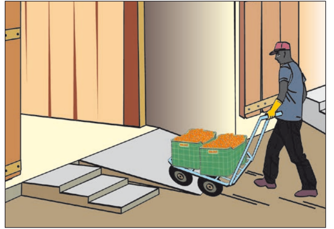
الشكل 2 - أ. زوّد بمعابر منحدرة بميل بسيط فوق الاختلاف المفاجئ في الارتفاع عند مدخل البناء.
