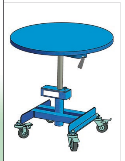
الشكل 24 - ت. صمّم منصات عمل دوارة بارتفاع مناسب للتقليل إلى أدنى حد ممكن من رفع الأشياء الثقيلة.
