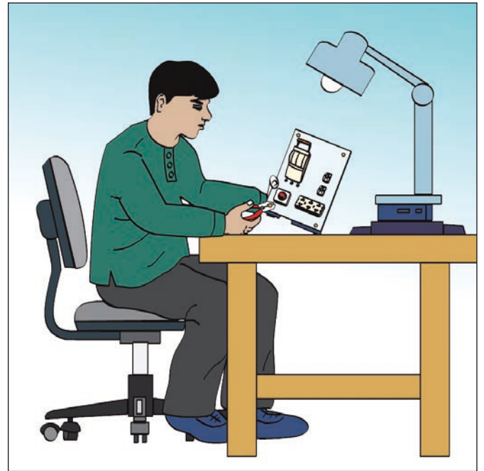
الشكل 50 - ت. زَوِّدْ بالمصابيح المُوَجَّهَة أثناء تأدية العمل الدقيق. بإمكانك التَّحَقُّق من المكان المناسب للمصابيح من خلال مراعاة نمط العمل المؤدى.
