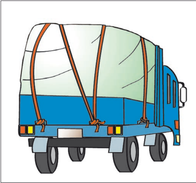
الشكل 46 - ب. تفيد تغطية المواد أو المنتجات التي تُنقل في الحيلولة دون تعرضها للضرر أو سقوطها.
