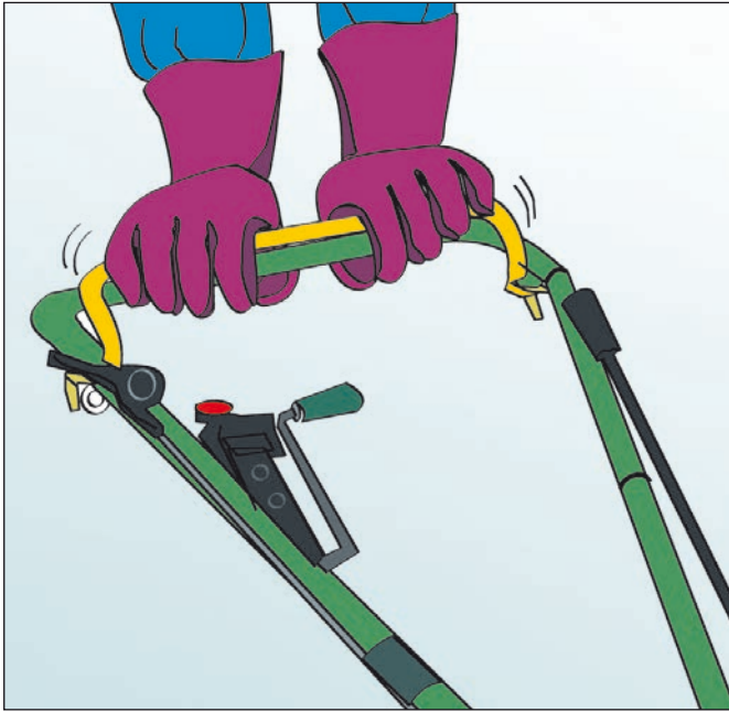
الشكل 37 - ب. إختَرِ الآلة التي تتوقف تلقائياً عندما تنطلق وسيلة التحكم.
