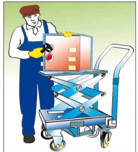
الشكل 11 - ث. وسيلة تعمل يدوياً لرفع الأشياء الثقيلة إلى مستوى سطح العمل.
