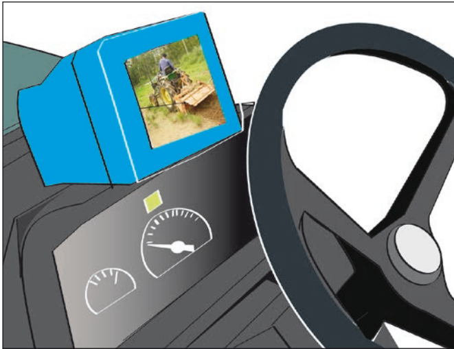
الشكل 48 - ث. يمكن تحسين الرؤية من قِبَل السائق بواسطة شاشة خاصة تُظهر الصورة من آلة تصوير مُتَبَنَّة على القسم الأمامي أو الخلفي للمركبة.
