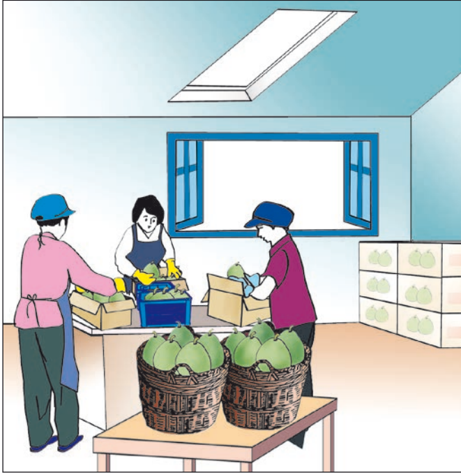
الشكل 49 - ب. إستخدَم مواداً شفافة أو لوحاً لداننياً (بلاستيكياً) شافئاً في السقف أو السطح بغية دخول كمية أكبر من ضوء النهار.
