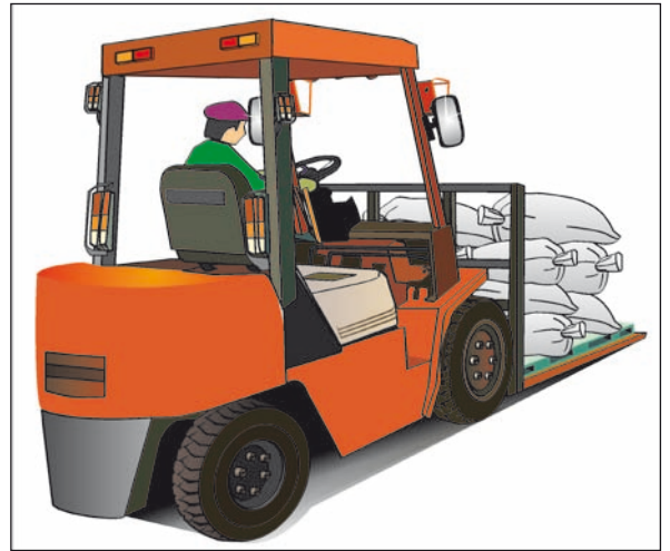
الشكل 11 - ت. رافعة شوكية تستطيع نقل أو رفع الأحمال الثقيلة بكفاءة.
