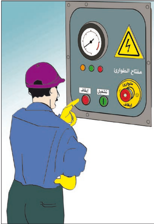
الشكل 86 - ب. إستخدم حروفاً أكبر في بطاقات التعريف الخاصة بالمفاتيح ووسائل الإظهار كي يستطيع العمال المسنون قراءتها بسهولة.
