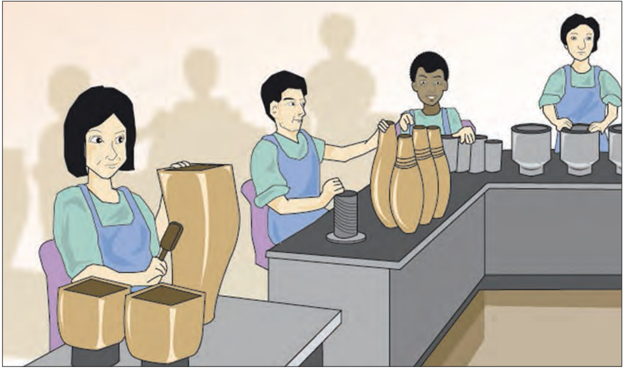
الشكل 6 أ. عدّل مقدار العمل لكل عامل لتفادي تعرض العمال لفرط العبء. حسّن مواقع العمل وسير العمل من وجهة نظر أرغونومية (تلاومية).
