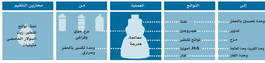
الشكل 22.78. عملية نزع الكبريت بوجود الهيدروجين
