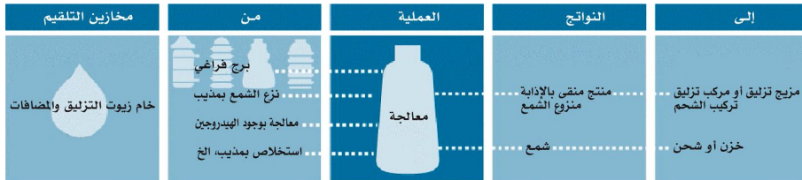
الشكل 18.78 . عملية تصنيع زيت التزليق والشمع
